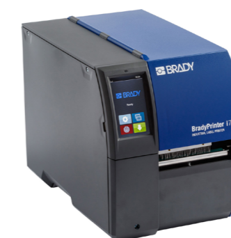
i7100 max šíře tisku 105.60 mm; rozlišení DPI 300/600, Ethernet / USB / SERIAL / volitelná Wi-Fi / Bluetooth
